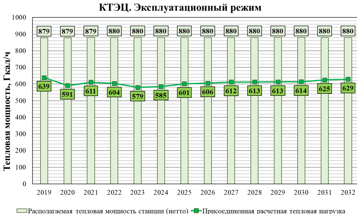
Рисунок 5.4 – Баланс тепловой мощности и подключенной нагрузки Кузнецкой ТЭЦ в эксплуатационном режиме
