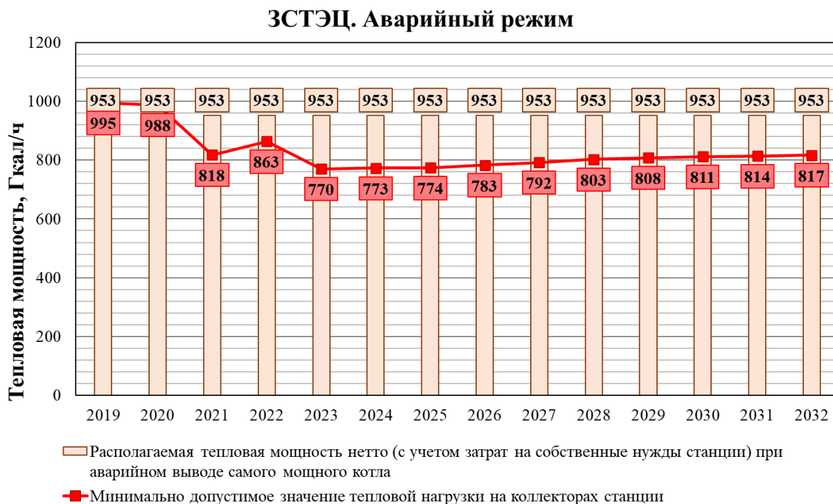
Рисунок 5.7 – Баланс тепловой мощности и подключенной нагрузки Западно-Сибирской ТЭЦ в аварийном режиме
